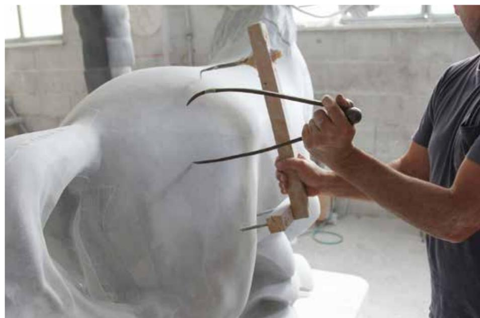
Sopra, il compasso e la croce utilizzati per la riproduzione dal modello in gesso all'opera, un procedimento oggi scomparso e sostituito dai moderni robot. Sotto, un gradino.
