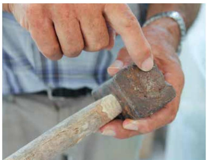
Da sinistra, robot di ultima generazione utilizzato nei laboratori di scultura; sopra un martello con l'anima di rame e a destra lo smeriglio, utilizzato per la rifinitura finale della superficie di una statua.
